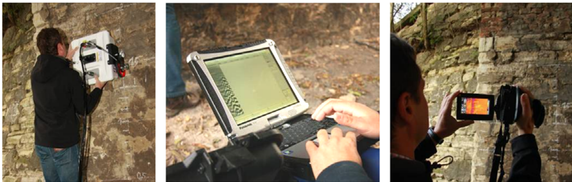
2. ábra: Falazott hídszerkezetek vizsgálata georadarral és infravörös hőmérsékletméréssel
