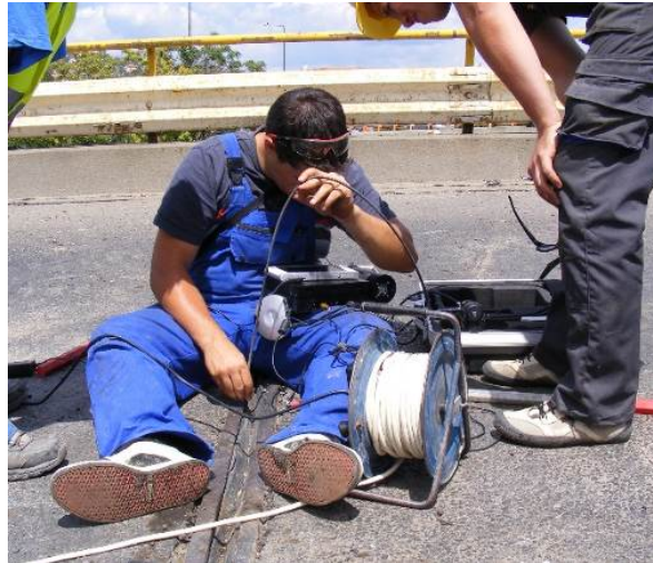
12. ábra: A dilatációk állapotának vizsgálata videoendoszkóppal
