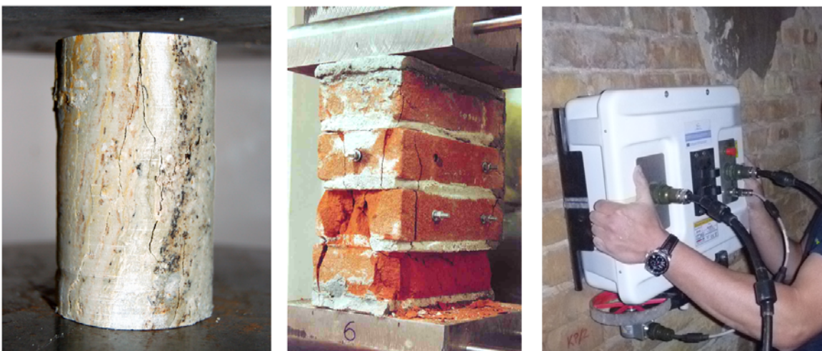
1. ábra: Falazott próbatestek roncsolásos és roncsolás-mentes vizsgálatai
